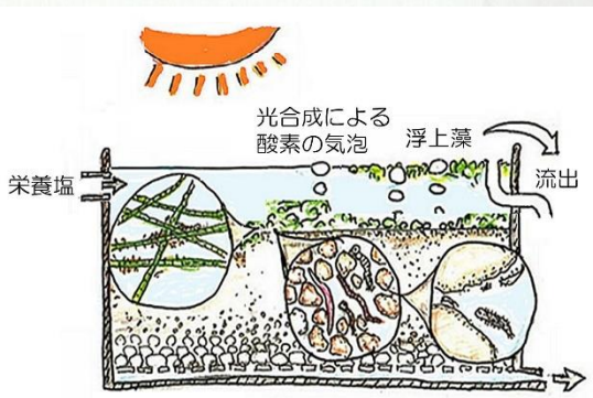
図43 生物浄化の仕組み
