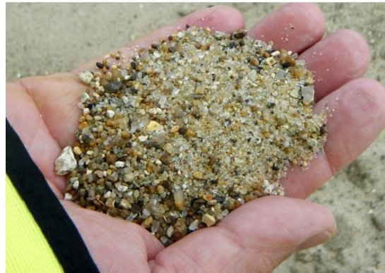
図19 テムズ水道の洗浄砂
